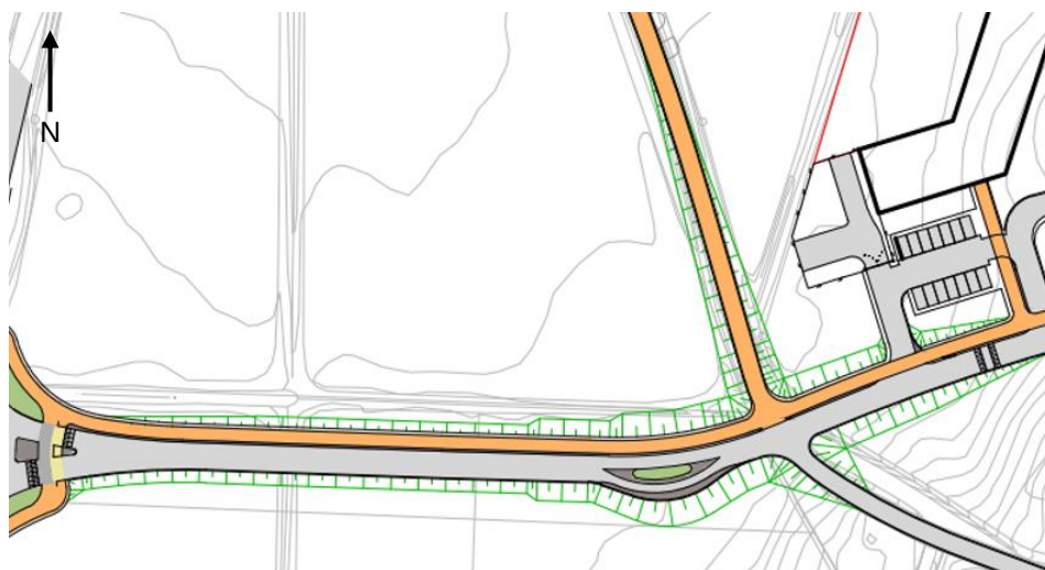
Figur 25 Illustration över partiet på huvudgatan som påverkas av höjdskillnader och som behöver fyllas upp. De gröna markeringarna visar den ungefärliga släntutbredningen. (Sweco)
