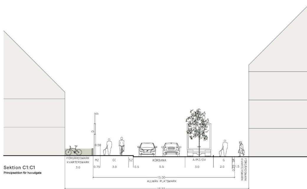
Figur 19 Principsektion C-C för huvudgata (Sweco/Krook & Tjäder)
