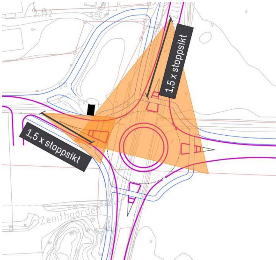
Figur 36 Figuren illustrerar framtagna sikttrianglar (stoppsikt innan korsning) i cirkulationen. Figuren visar att transformatorstationen inte utgör ett hinder. (Sweco)
